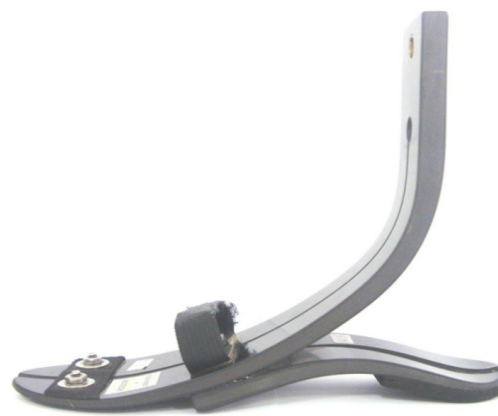
تصویر ۲: پنجه پروتزی فلکس فوت مورد آزمایش
