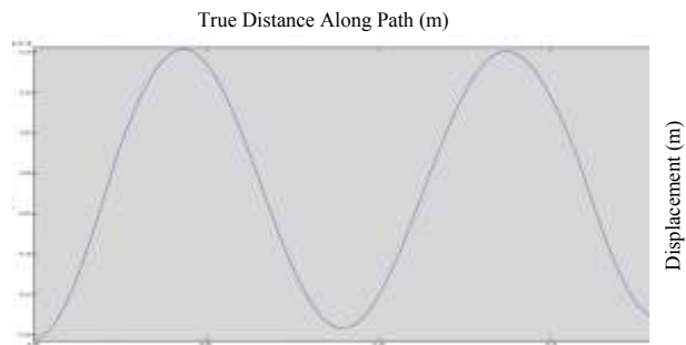
شکل ۳: انتشار موج برشی در مدل المان محدود با فرکانس ۲۵ هرتز و الاستیسیته ۱۵ و ۱۳ کیلوپاسکال
