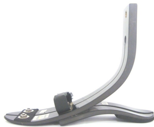
تصویر ۲: پنجه پروتزی فلکس فوت مورد آزمایش
