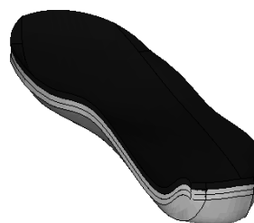
شکل ۲: کفی سه لایه ارتوز با ضخامت متغیر، براساس منحنی یک کفی استاندارد.
